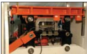
Rolete de rosca patenteado com terceiro movimento
