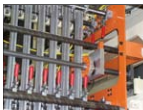
Sistema de guia de alimentação servo controlado com troca rápida dos guias de chapa
